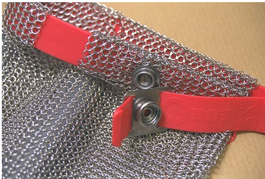
Bild 15: Druckknopfverschluss; auf dem Band sind die Informationen eingepreßt (Farbe des Bandes zur Kennzeichnung der Größe, siehe Tabelle 1)
