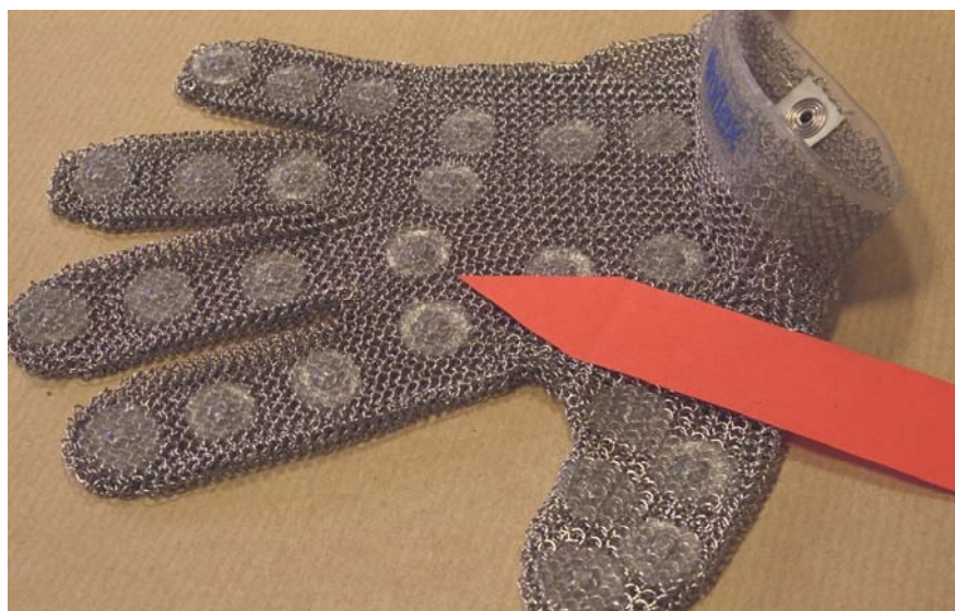
Bild 12: Metallgeflechthandschuhe mit rutschhemmenden Noppen auf der Handfläche
