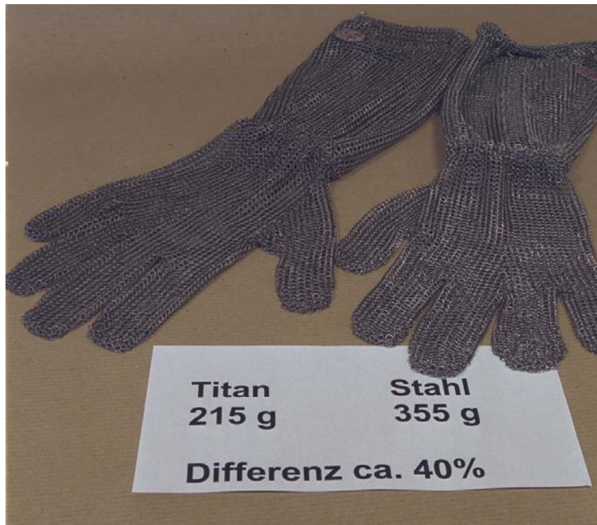
Bild 13: Vergleich von Titan- mit Stahlringgeflechthandschuhen
